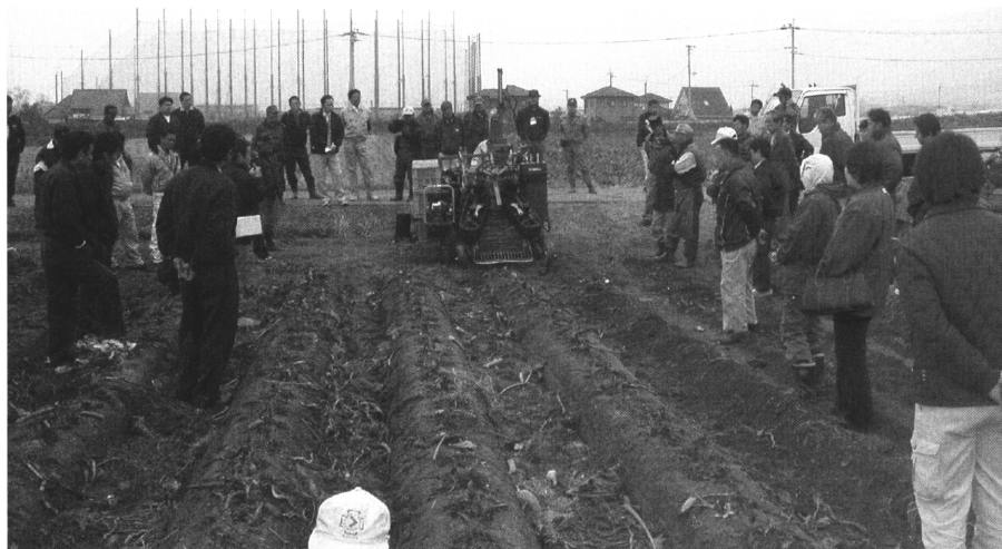
写真3. 開発中の小型一工程サトイモ収穫機 (原図 河野靖)
